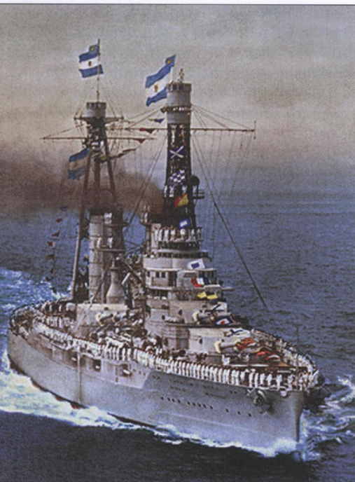
Аргентинский линкор «Морено», 1915 г. Водоизмещение – 30600 т, скорость – 22,5 узла, вооружение: 12 орудий калибра 305 мм и 12 – 152-мм
